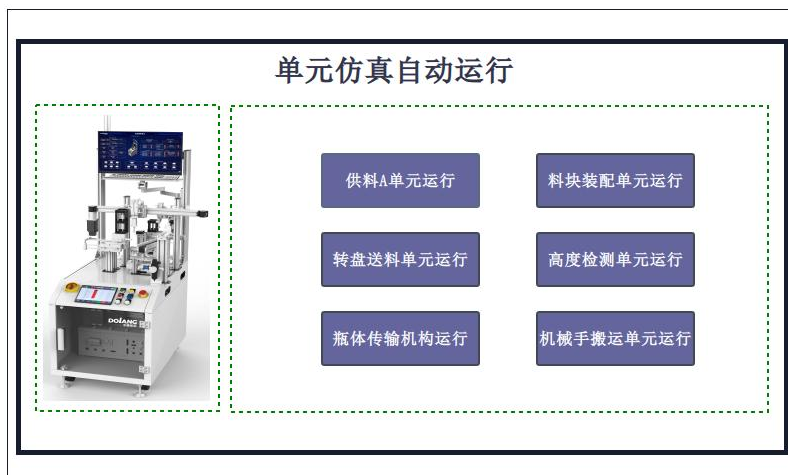
图 4 触摸屏（HMI）单元仿真自动运行（参考）
