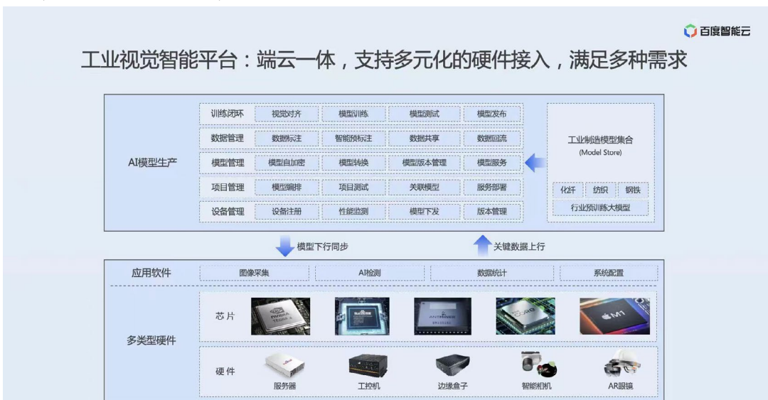
图 34 百度开物智能工业质检解决方案架构图
