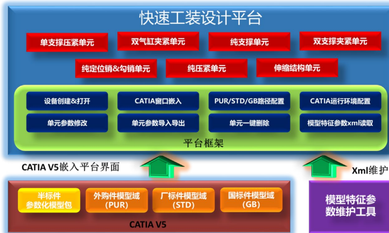
图 29 快速工装设计平台架构图
