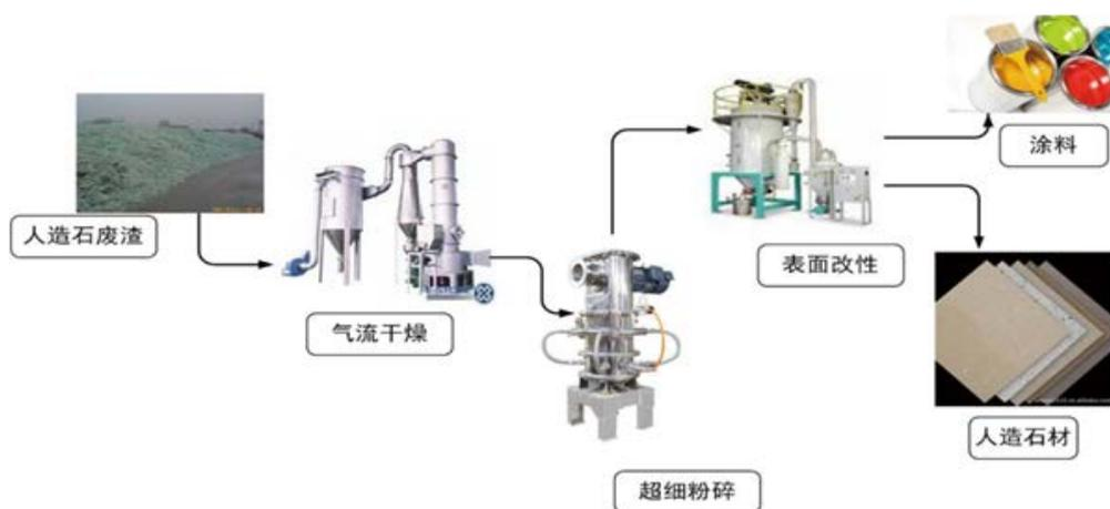
石材加工废渣循环利用技术路线
