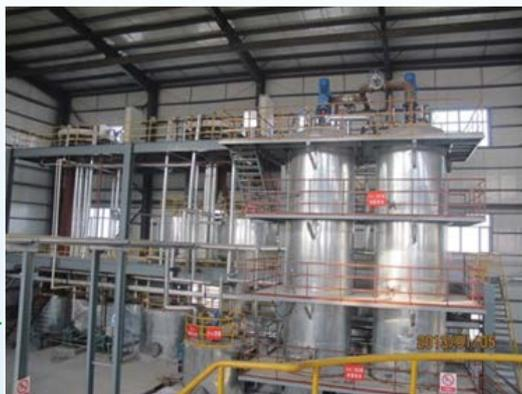
纳米生物碳酸钙反应合成工业装置
