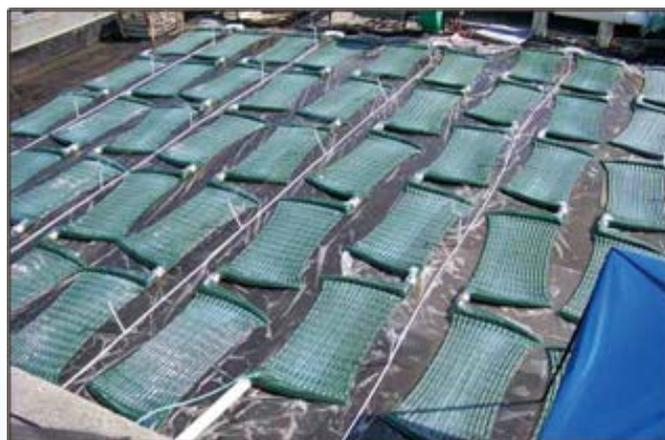
**技术特点：**软体板式光反应器采用廉价材料，大幅度降低反应器造价；特殊的内部结构可以使微藻细胞以较高的频率在光区和暗区穿梭，大幅度提高光能利用率。
