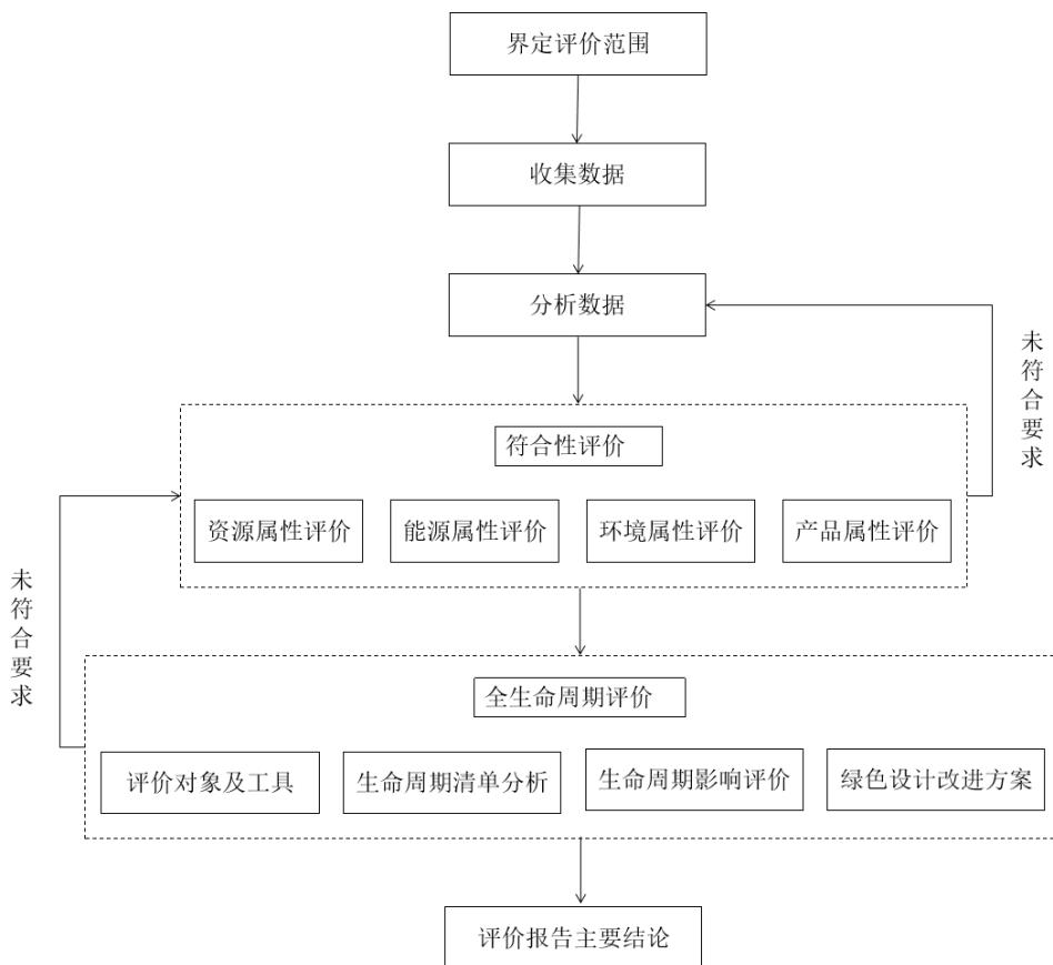
图1 石油化工用隔爆型离心通风机绿色产品评价流程
