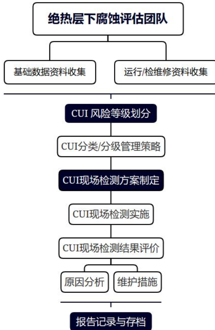
图 1 绝热层下腐蚀评估与检查的基本程序
