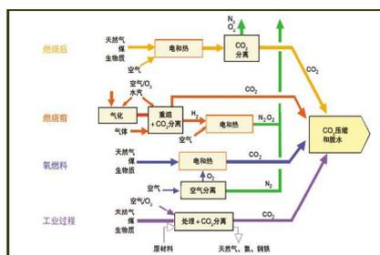
图 1  $CO_2$  捕获流程和系统概况
