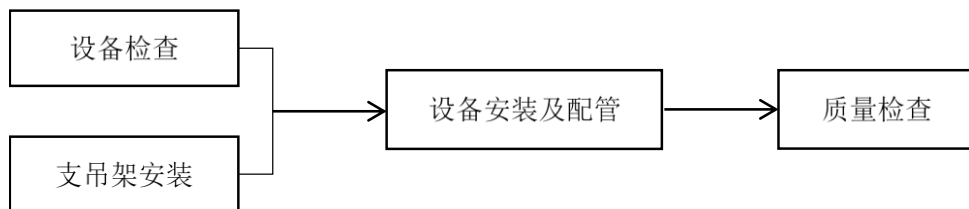
图 5.3.6 空调末端装置安装工序
