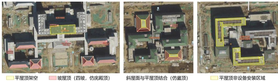
图 4.2.1 不同建筑屋顶形式可利用面积示意图
