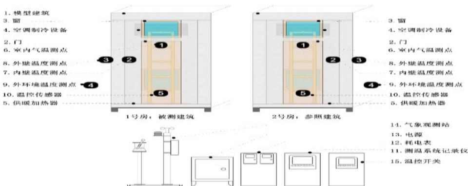
图 B3.1 对比测试设备及系统示意图
