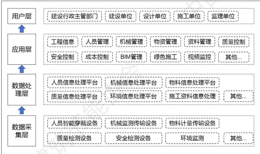
图 6.4.6 智慧工地系统架构示意图
