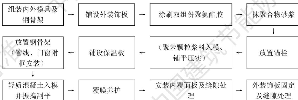
图 7.2.1 复合外墙板制作流程图
