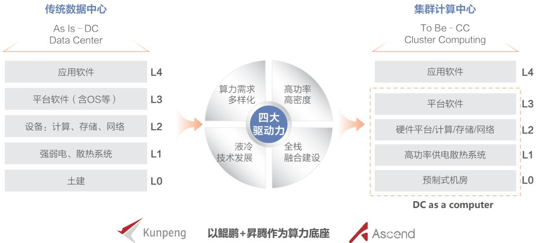
图18 数据中心建设从部件堆叠走向全栈一体化
