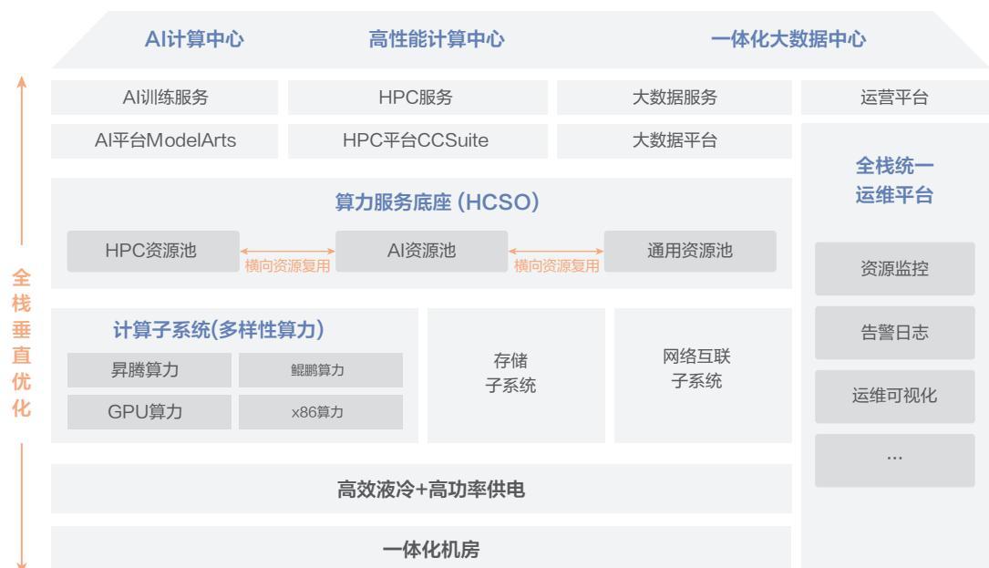
图19 集群计算解决方案整体架构
