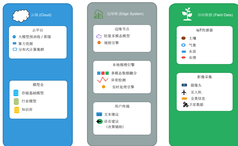
图 5.1: 多模态大模型及农业数据架构图
