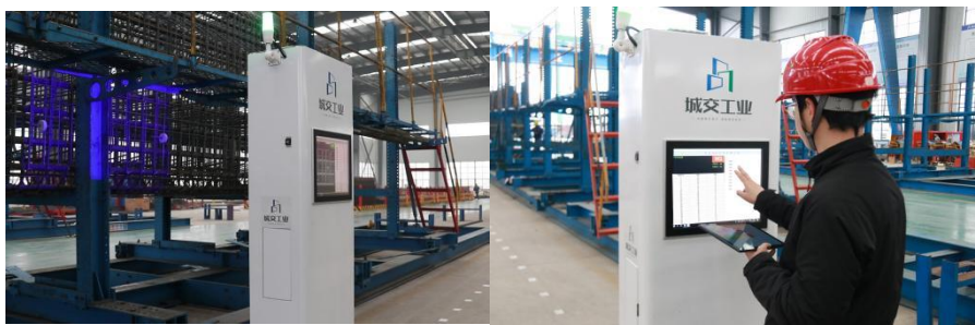
图 3 立柱箍筋间距检测机器人
