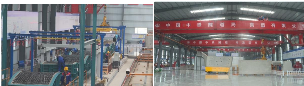
图 8 管片厂流水生产线
