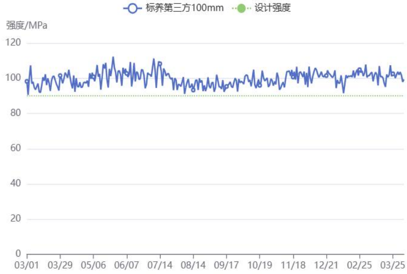
图6 中部地区混凝土28d强度波动曲线
