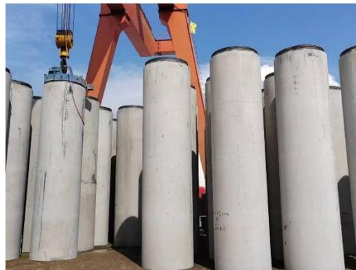
(f) 管芯混凝土脱模成型
