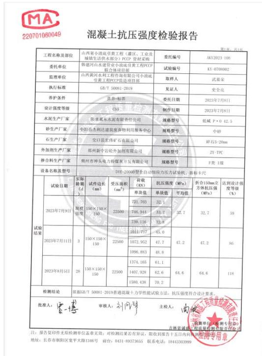
图 5 实验室检验模块混凝土抗压检测报告
