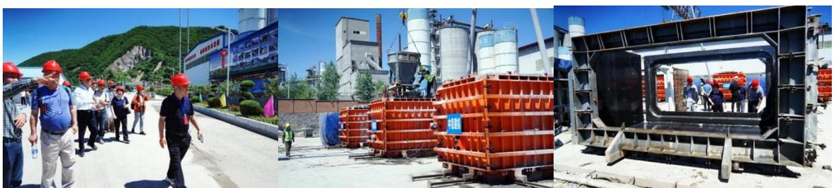
(4) 2024年7月8日,标准编制组一行3人前往山西鑫联智慧科技股份有限公司,对《水泥制品工艺技术规范 第8部分:预制混凝土箱涵》行业标准的制定进行了现场试验验证工作。本次试验验证的预制混凝土箱涵规格尺寸为2100\*2000\*2500(内宽\*内高\*壁厚\*长度)用于临汾市中央大道排水工程和1800\*1500\*2500(内宽\*内高\*壁厚\*长度),用于临汾
