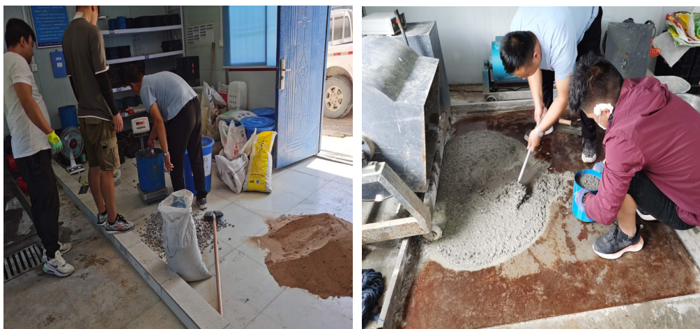
图 C.0.3-2 沙漠砂混凝土配合比试拌
