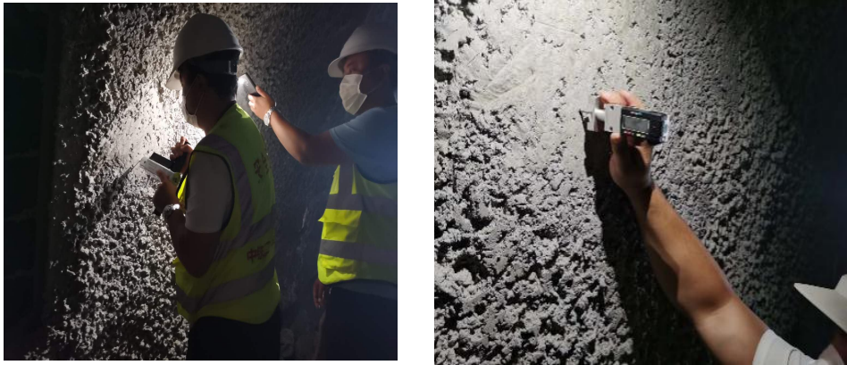
图 C.0.3-4 射钉法检测沙漠砂喷射混凝土 1d 实体强度
