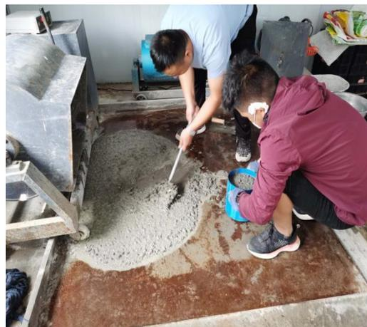
图 5.3.7-2 沙漠砂混凝土扩展度及容重试验
