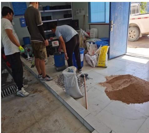
图 5.3.7-1 沙漠砂混凝土配合比试验
