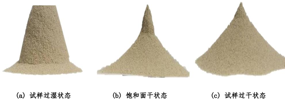
图 4.6.2 不同含水量的沙漠砂堆积形状
