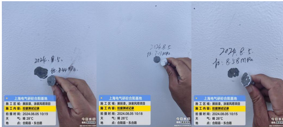
图1 合阳基地聚氨酯底面合一涂料粘结强度测试
