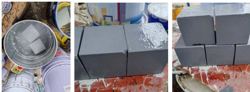
图2 混凝土涂层试块氢氧化钙10天测泡测试
