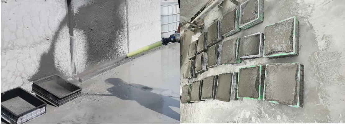
图 3-2 超高性能混凝土大板喷射
