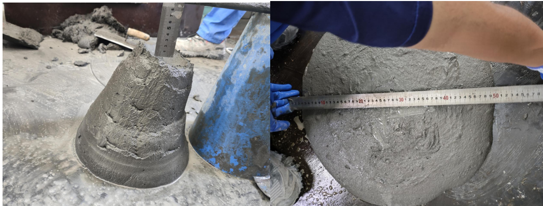
图 3-1 超高性能混凝土工作性能测试
