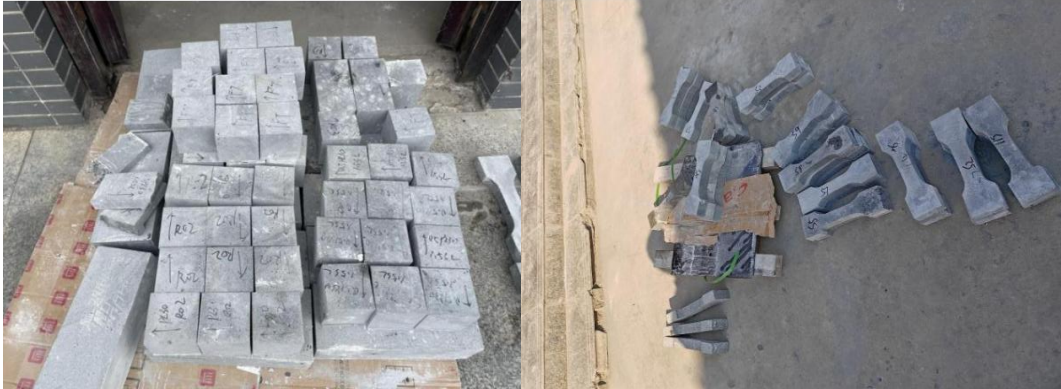
图 3-3 抗压强度、抗弯强度、抗拉强度和粘结强度测试试验切割成型
