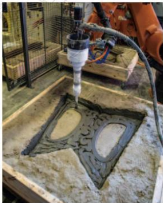
图示 3D 水泥打印和制作过程
