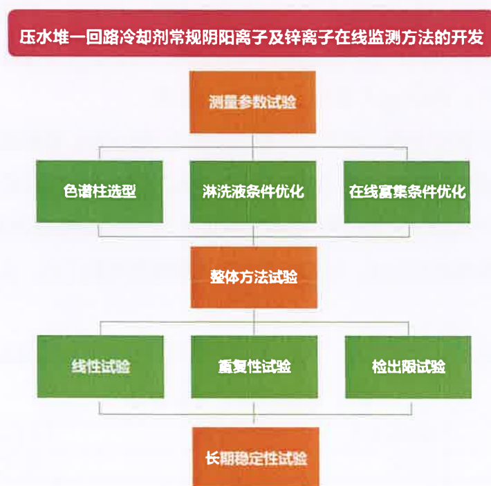
图 1 压水堆一回路冷却剂常规阴阳离子及锌离子在线监测方法的开发技术路线 图
