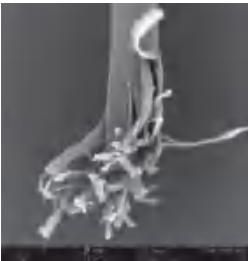
莱赛尔纤维原纤化SEM图像
