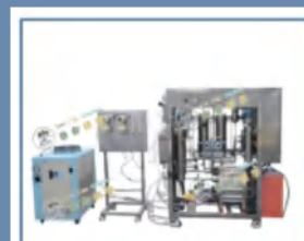
碱水电解氢实验系统
