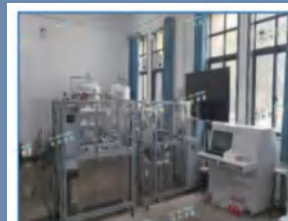
卡诺电池储能实验系统
