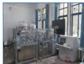
卡诺电池储能实验系统
