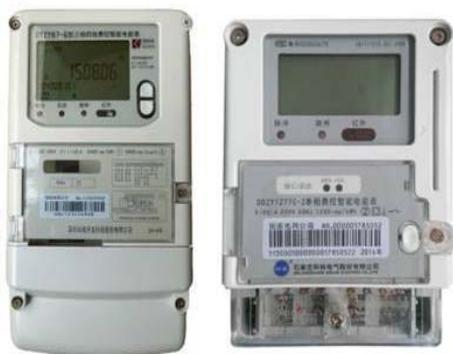
由测量单元、数据处理单元、通信单元等组成具有电能量计量、数据处理、实时监测、自动控制、信息交互等功能的电能表称为智能电能表。
