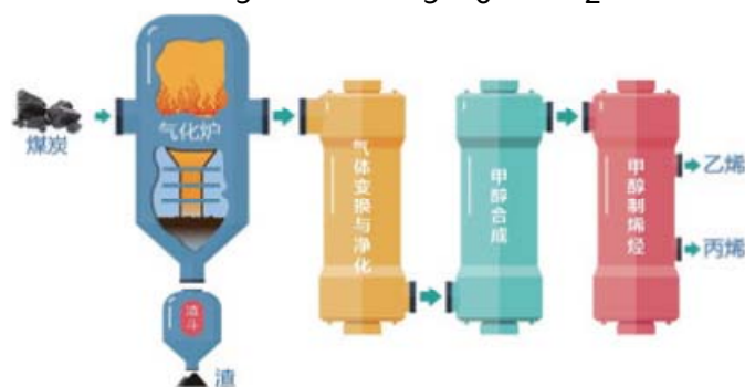
图f 煤气化得到甲醇，再由甲醇制烯烃的工艺示意图
