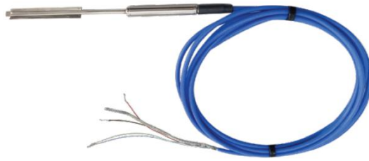
图 C.4 电阻应变计实物图
