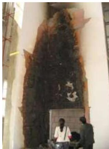
拆除燃烧区域后，试验墙状态
