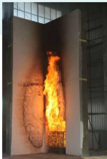
15分钟，燃烧最猛烈，主墙防护层烧穿，副墙1线防护层下出现明火
