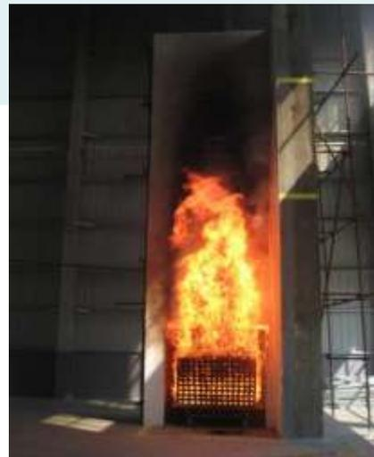
10分钟，达到燃烧最猛烈状态，副墙出现膨胀，燃烧室前出现滴落液体，周边燃烧剧烈，XPS在高温下出现熔融滴落。
