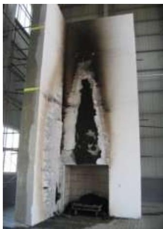
燃烧完1h的试验墙状态
