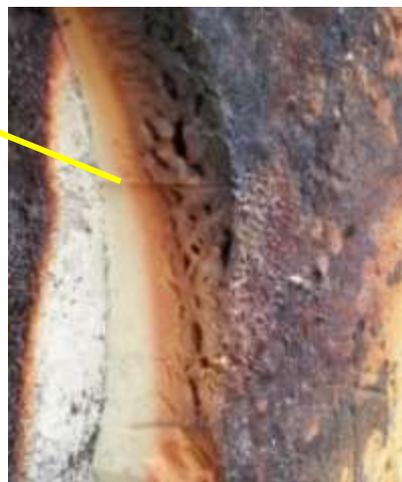
注：上图为中国建科院做的聚氨酯大型防火试验，整个过程聚氨酯薄抹灰体系试验墙在火焰中炙烧近30分钟，整个过程没有出现轰然和坍塌现象。具有良好的防止火势蔓延的作用。
