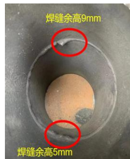
管道特征复杂 (高焊缝、连续弯头、斜接弯头)
