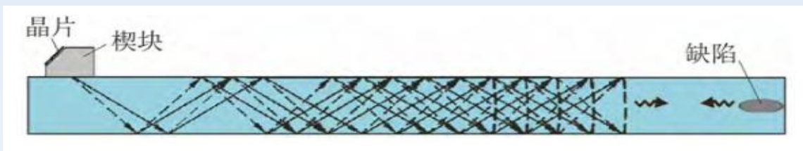
金属材料中导波的产生
