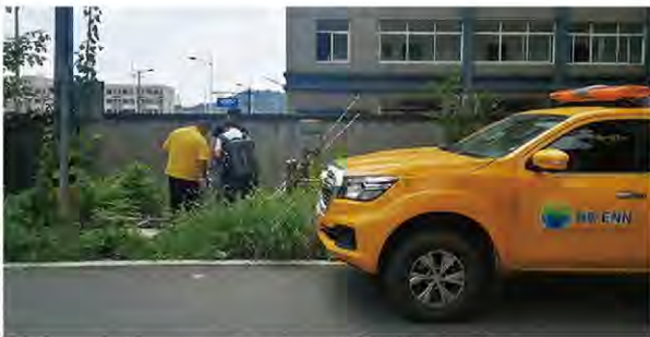
ZERO 车载式高精度天然气泄漏检测车
