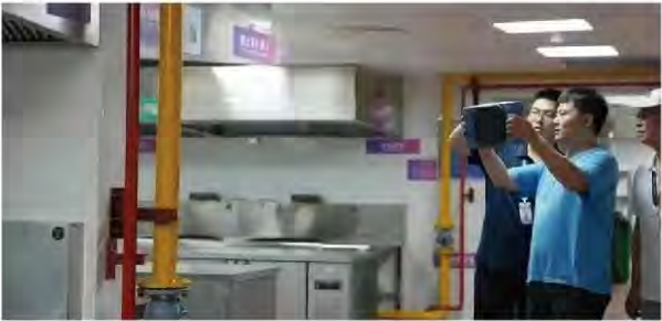
工作人员正在使用讯飞声学成像仪
