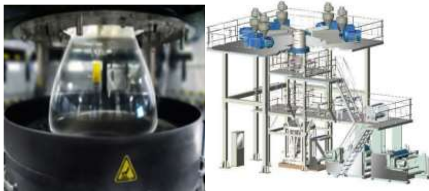
图3 下吹法生产多层共挤设备
