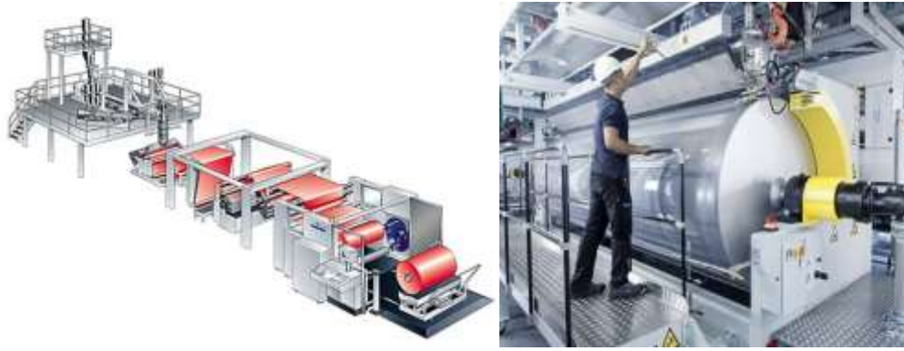
图 4 流延法生产多层共挤设备
