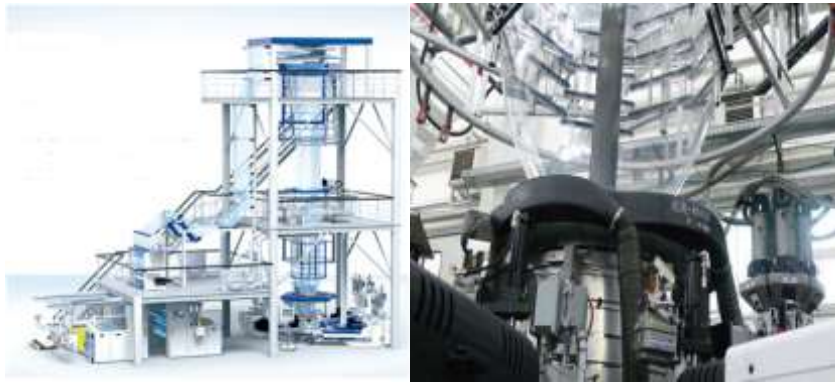
图2 上吹法生产多层共挤设备
