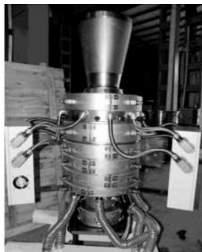
(a) 上斜叠加型机头 (b) 下斜叠加型机头
