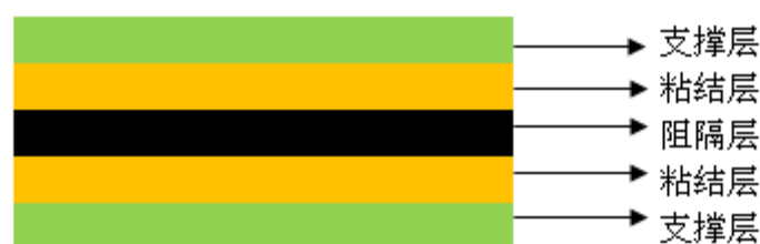
图 1 典型的 5 层共挤膜结构图
