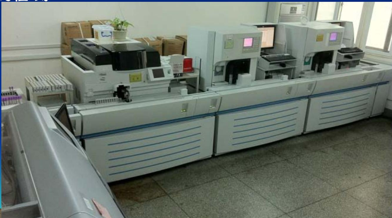
生化免疫检测：从单台的生化或免疫检测设备到能串联多台生化以及免疫检测系统，同时还包括了标本的前处理和后处理工作站
